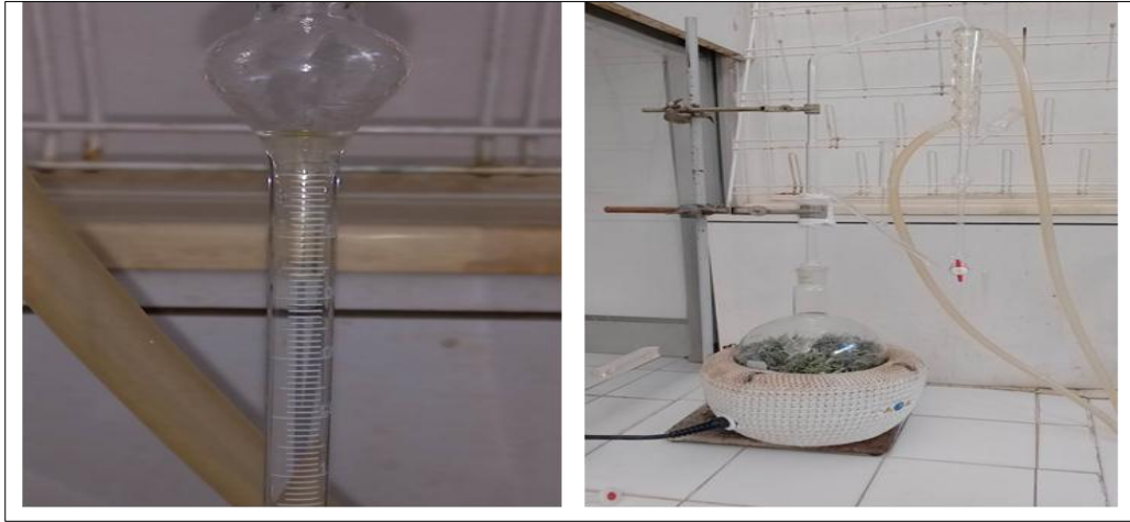
الشكل (26): صور لاستخلاص الزيوت الأساسية باستعمال جهاز Clevenger
